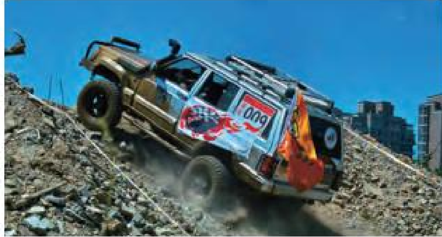
图 8.1-4 汽车上坡时必须使用低速档
